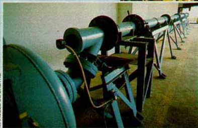
Abaixo, o canhão arremessador de frangos, que os atira em alta velocidade sobre maquete do cockpit, à direita, para testar a resistência aos choques com aves durante o voo
