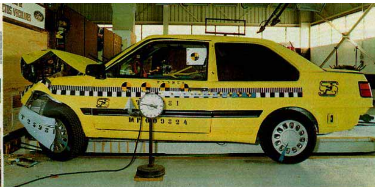
Se a lataria amassa, numa batida a 50 km/h, o passageiro tem mais tempo para perder velocidade e se machuca menos
