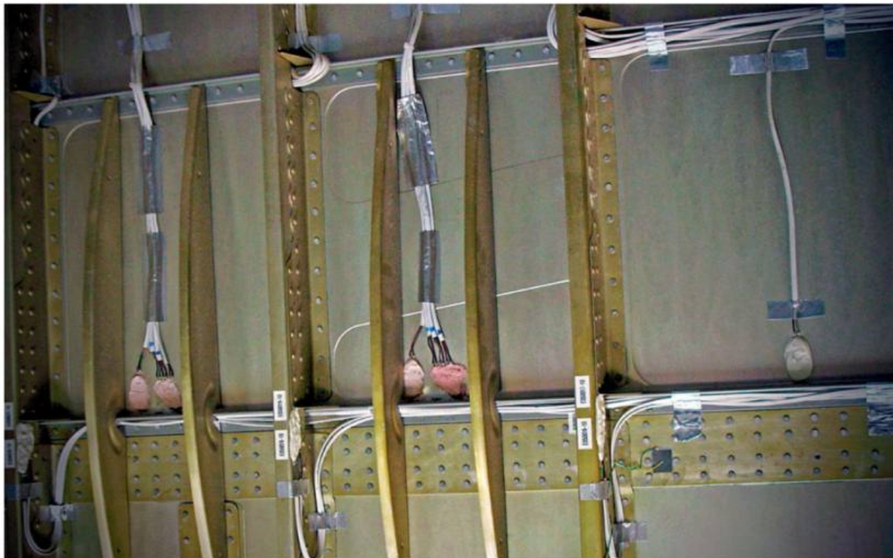
Figura 2. Cerâmicas piezelétricas usadas no monitoramento de integridade estrutural da fuselagem de um avião
