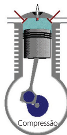
Figura 10.4: Etapa de compressão em um motor
