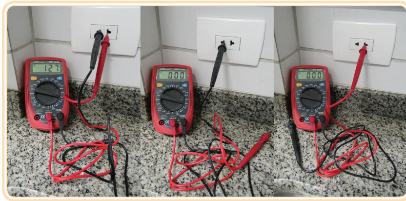
Figura 13.2: Voltímetro medindo a ddp de uma tomada. Repare que quando só um terminal é medido o instrumento indica zero
