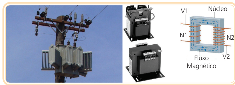
Figura 16.5: Diferentes tipos de transformadores e o esquema de funcionamento de um transformador
