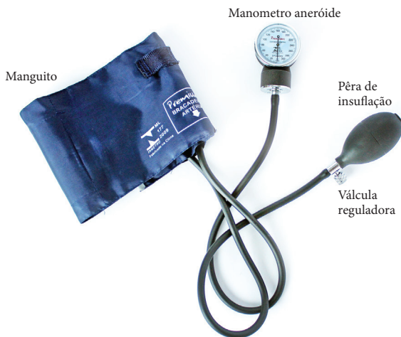
Figura 8 – Composição do esfigmomanômetro
