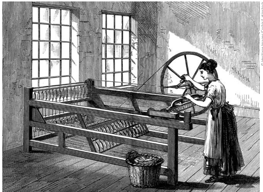
Uma das primeiras máquinas de fiar, inventada por James Hargreaves, em 1764, que seria utilizada nas fábricas de tecido. Ela era até 18 vezes mais rápida que um tear manual. [Gravura, c. 1880.]
