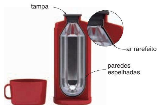
Esquema simplificado de uma garrafa térmica.
