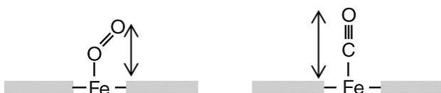
Figura 16.4: Ligação dos gases oxigênio e monóxido de carbono ao ferro do heme. As barras laterais representam o restante da molécula de heme. Repare que o espaço requerido para cada ligação acontecer (representado pelas setas) é diferente.
