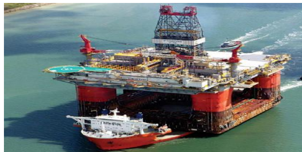
Figura 24 - Transporte da plataforma P-40.
