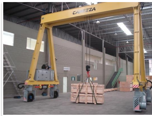
Figura 11 -Pórtico sobre pneu
