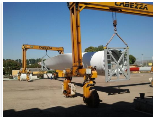
Figura 12 - Pórtico sobre pneu
