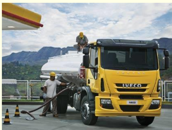
Figura 8 - Descarga de Caminhão de Combustível em Posto de Gasolina
