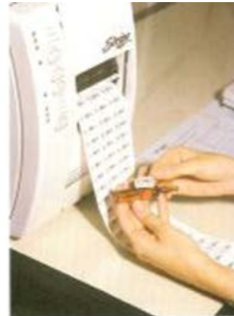
Figura 6: Exemplo de máquina de produção de etiquetas para código de barras – etiquetas contendo código de barras do produto, nome do medicamento ou correlato, lote, forma farmacêutica, dosagem data de validade.
