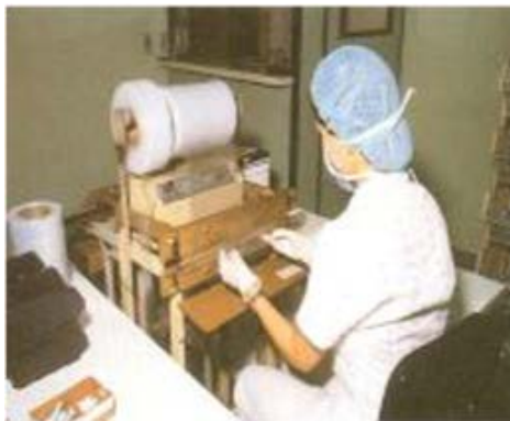
Figura 4: Exemplo de unitarização de comprimidos na máquina seladora – fase que antecede o código de barras.
